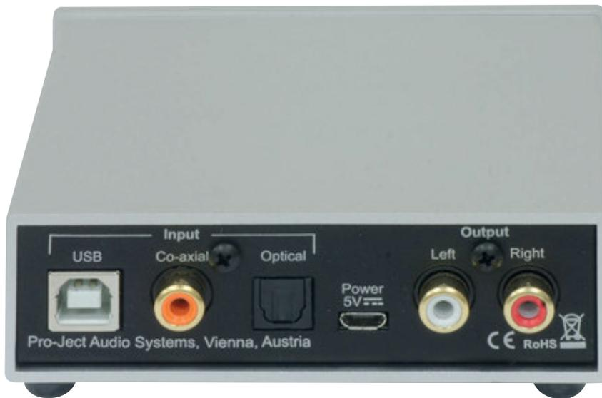
Sul pannello posteriore troviamo sulla sinistra i connettori dei tre ingressi digitali USB, coassiale e ottico e sulla destra il connettore per l'alimentatore esterno e quelli per l'uscita linea.
