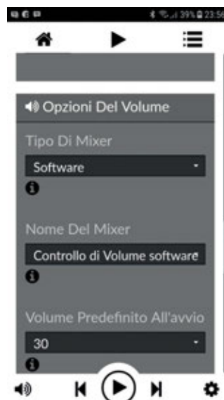
Figura 3. È necessario configurare il controllo del volume se si vuole pilotare anche questo dall'app di controllo.
