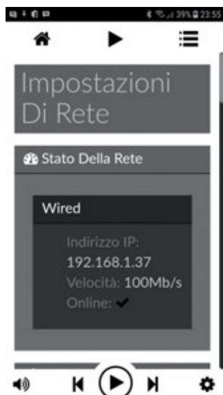
Figura 5. Dal menù delle impostazioni di rete è possibile ricavare l'indirizzo IP assegnato allo streamer nella rete casalinga.
