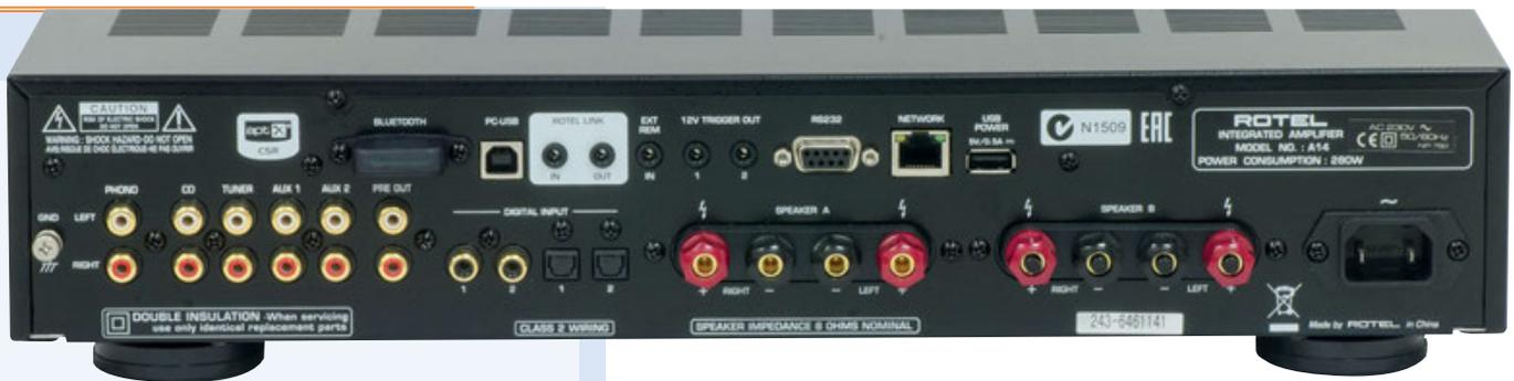
Il pannello posteriore dell'apparecchio è densamente abitato. Oltre agli ingressi troviamo due coppie di uscite per i diffusori e un cospicuo numero di connessioni di controllo: trigger, sensore a infrarossi esterno, porta RS-232 e porta ethernet per il controllo remoto via IP.
