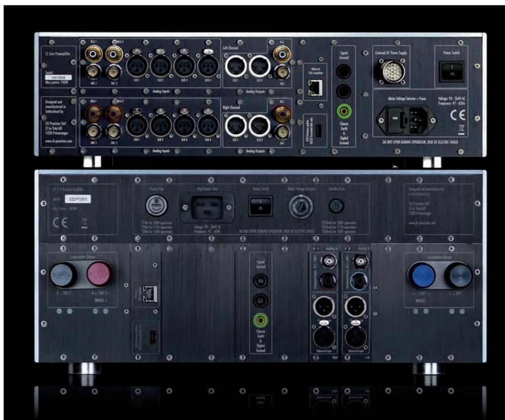
La costruzione è completamente modulare, e come si può notare ogni dettaglio è curato in modo maniacale. I connettori sono di tipo professionale, e l'alluminio utilizzato è del tipo a-magnetico. Notare sul preamplificatore, in alto a destra, il connettore per l'alimentatore separato, e in basso sul finale, i binding-post di uscita fatti ad-hoc per CH e in grado di serrare qualsiasi tipo di terminazione.
