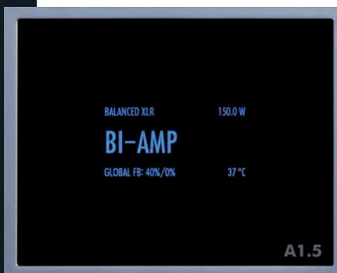
*Splendido il display AMOLED 480X272 di cui sono dotate tutte le elettroniche CH. Su A1.5 è possibile regolare la controeazione sia locale che generale, in modo da adattare alla perfezione l'amplificatore al diffusore al quale viene collegato. Allo stesso modo si può scegliere se utilizzarlo in configurazione stereo, mono, o bi-amp.*
