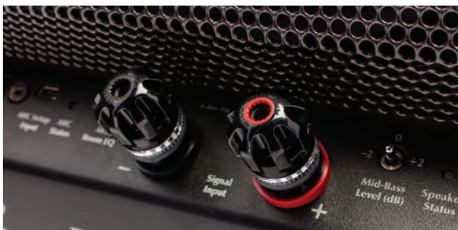
Molto belli e di eccellente qualità i binding post di ingresso delle ESL13. Notare a destra il controllo di livello di emissione della gamma medio/bassa, all'incirca all'incrocio tra i woofer e il pannello.
