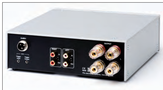
Amp Box DS2 è un finale in classe D avanzato e capace di oltre 100W su 8 ohm. E' in grado di pilotare carichi anche molto difficili. Notare i grossi morsetti di uscita che ospitano sia cavi spellati che banana e forchetta, e gli RCA con bypass, in modo da poter collegare altri finali in cascata.
