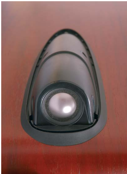
Il tweeter con involucro separato, di derivazione Nautilus, con il tubo chiuso posteriore a volume e forma calibrati, è più efficiente e con minor distorsione, grazie a nuove tecnologie adottate.
