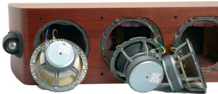
Si apprezzano i cestelli pressofusi degli altoparlanti a cono; a sinistra il tipico e costoso midrange "FST" con membrana in kevlar, qui senza pressione regolabile posteriore; a destra i due compatti woofer potenti e veloci.
