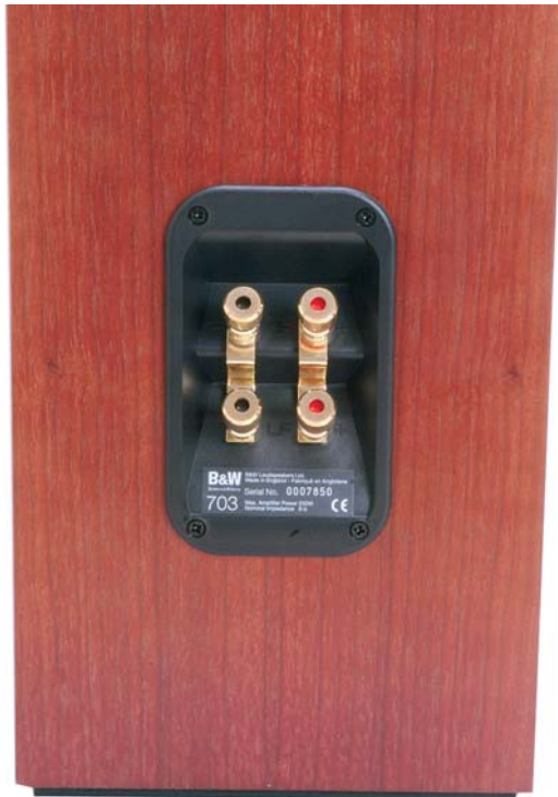
La morsetteria è abbastanza classica, con 4 robuste connessioni dorate atte al bi-wiring/bi-amping su due livelli e con ponticelli estraibili da tenere in sito per l'impiego standard a due poli.
