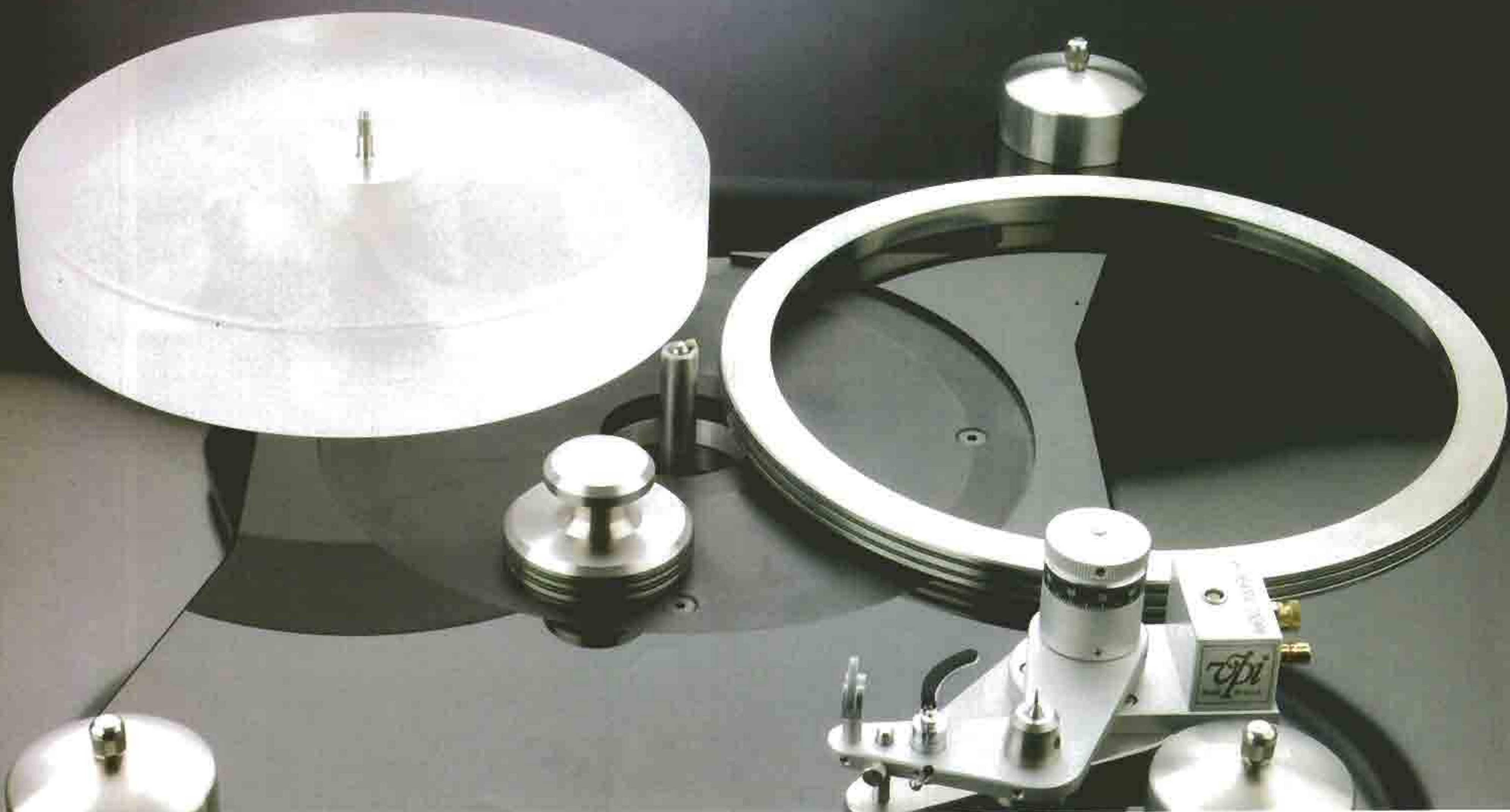
Il piatto in acrilico semitrasparente ha ottime caratteristiche di rigidità e smorzamento. Per aumentare la massa periferica e il conseguente effetto volano abbiamo un anello metallico da appoggiare sul bordo esterno dell'acrilico.
