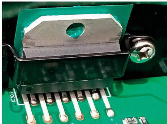
I due chip LM3886, uno per canale, sono fissati al dissipatore attraverso una staffa che migliora il contatto e la conduzione termica.
