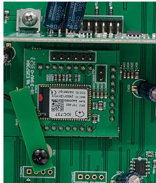
La sezione digitale, DAC e modulo ricevente Bluetooth, è fisicamente separata dalle altre.
