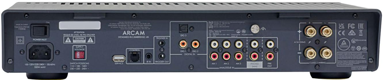
Il pannello posteriore offre connessioni analogiche e digitali con terminazioni di buona qualità. I morsetti per i cavi potenza non sono isolati ma il profilo in plastica posto sui bordi laterali e superiore del telaio copre tutti i connettori con vantaggi anche estetici e di protezione del cablaggio.
