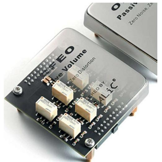
Vista in trasparenza del modulo Orfeo per il controllo del volume.
