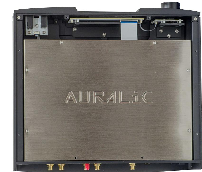
Una volta rimosso il pesante fondello in acciaio si può osservare lo Unity Chassis posto all'interno.
