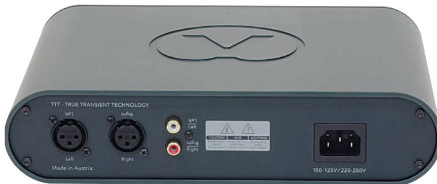
Pochi fronzoli anche nel pannello posteriore: sono presenti solo le connessioni per l'ingresso del segnale, bilanciato e sbilanciato, e l'alimentazione.
