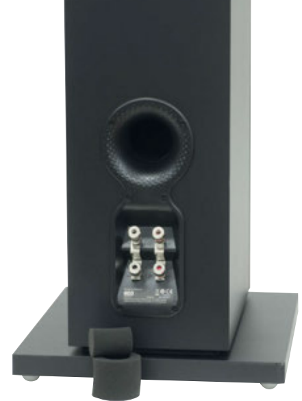
Il retro del diffusore. Notiamo i cilindri coassiali in dotazione per ridurre fortemente l'emissione del condotto di accordo, la superficie interna del condotto stesso e la doppia connessione di ingresso.
