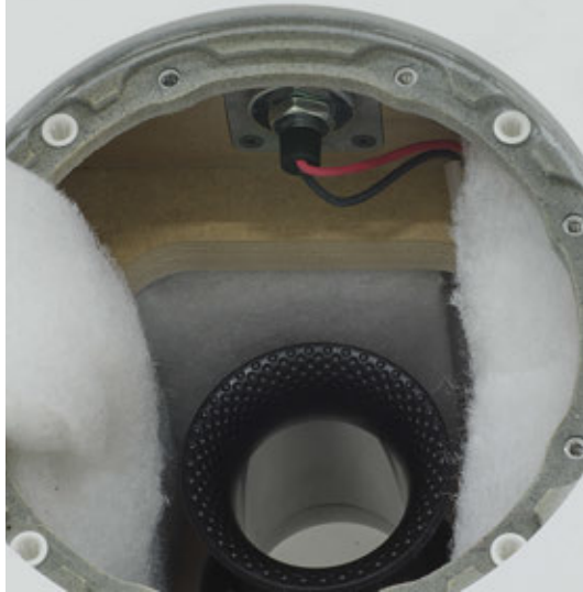
Il fissaggio del tweeter sul cabinet è realizzato con un disaccoppiatore meccanico. Notare la terminazione interna del condotto di accordo.
