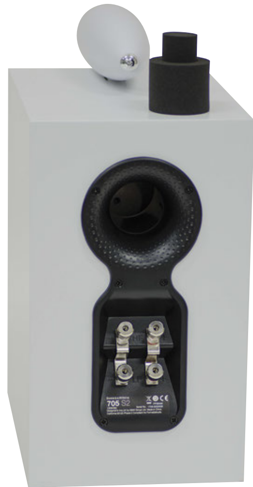
Il retro del diffusore è riempito dal monoblocco di materiale plastico smorzato che comprende il condotto di accordo e la vaschetta portacontatti. Notare i due cilindri coassiali di poliuretano per il controllo delle basse frequenze.
