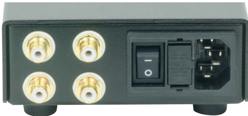
Il pannello posteriore è essenziale: tasto di accensione e connettori RCA di ingresso e uscita. L'indicazione del verso di connessione è riportato sul fondo dell'apparecchio.
