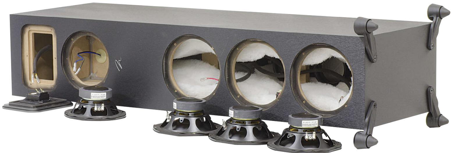
*Il mobile è realizzato in MDF con il pannello frontale di spessore differenziato. Il midrange dispone di un volume dedicato anch'esso dotato di assorbente acustico (rimosso in foto) dello stesso tipo di quello sintetico, abbondantemente posizionato all'interno del volume, unico, del diffusore.*
