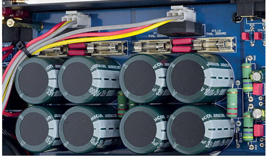
L'alimentazione dei due canali è separata, come si può notare nella foto che evidenzia anche le batterie di condensatori elettrolitici Jamicon da 10.000 µF.
