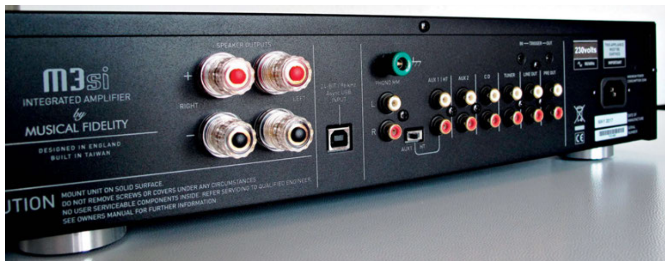
Sul pannello posteriore dell'M3si spiccano i morsetti per le acustiche, molto versatili e di buona robustezza.
