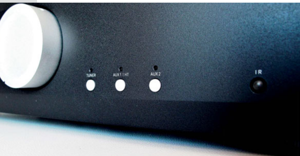
Parte destra del frontale, con tastini a sfioramento e - a destra - il ricevitore infrarossi per il telecomando.
