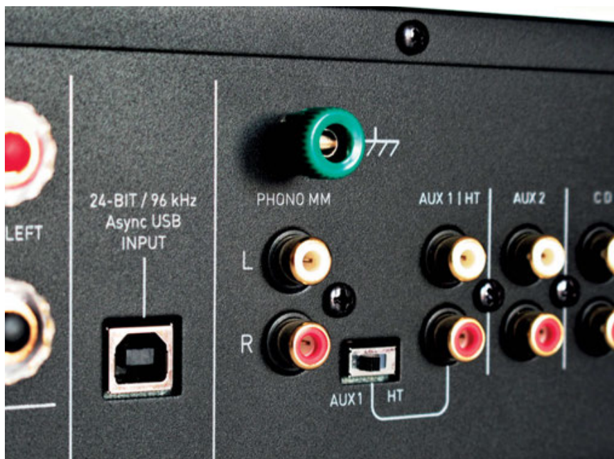
Close-up dell'ingresso USB per PC, accanto quello per testine fonografiche a magnete mobile, gli estremi tecnologici dell'audio quasi a toccarsi: a ciascuno il suo. Nei pressi, il commutatore AUX1/HT per trasformare l'ingresso linea AUX1 in finale per applicazioni Home Theater bypassando la sezione di preamplificazione.
