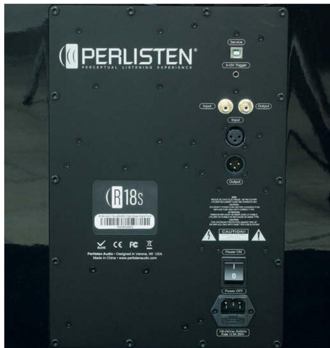
Il pannello posteriore che sorregge l'abbondante elettronica è ampio, per fornire superficie di dissipazione termica, ma appare quasi deserto: praticamente solo ingressi e uscite, monofoniche ma doppiate in bilanciato e sbilanciato. Tutta l'interfaccia utente è delegata al piccolo display touch, sulla faccia superiore del mobile, e soprattutto all'app con Bluetooth, da installare su dispositivo portatile, iOS o Android.
