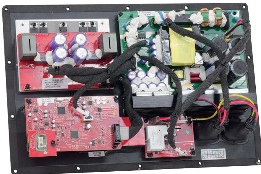
*L'elettronica è articolata tra diverse schede specializzate per le varie funzioni. La maggiore è l'alimentatore switching. A fianco l'amplificatore da 1 kW in classe D, di apparenza incredibilmente semplice confrontato alla sottostante scheda digitale con conversione AD, DSP, conversione DA e microcomputer con ricetrasmittitore Bluetooth, per la gestione dell'interfaccia utente. La più piccola scheda si occupa del front-end analogico, bilanciato e sbilanciato.*
