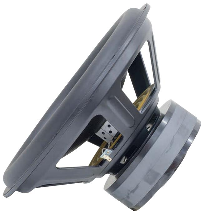
*L'altoparlante ha un diaframma a profilo curvo, stampato in unico pezzo di composito a base di fibra di vetro. Il cestello è in lamiera stampata, con ampi spazi di ventilazione. I rapporti dimensionali sono da woofer normale, senza vistose esagerazioni, ma tutto è in scala amplificata.*
