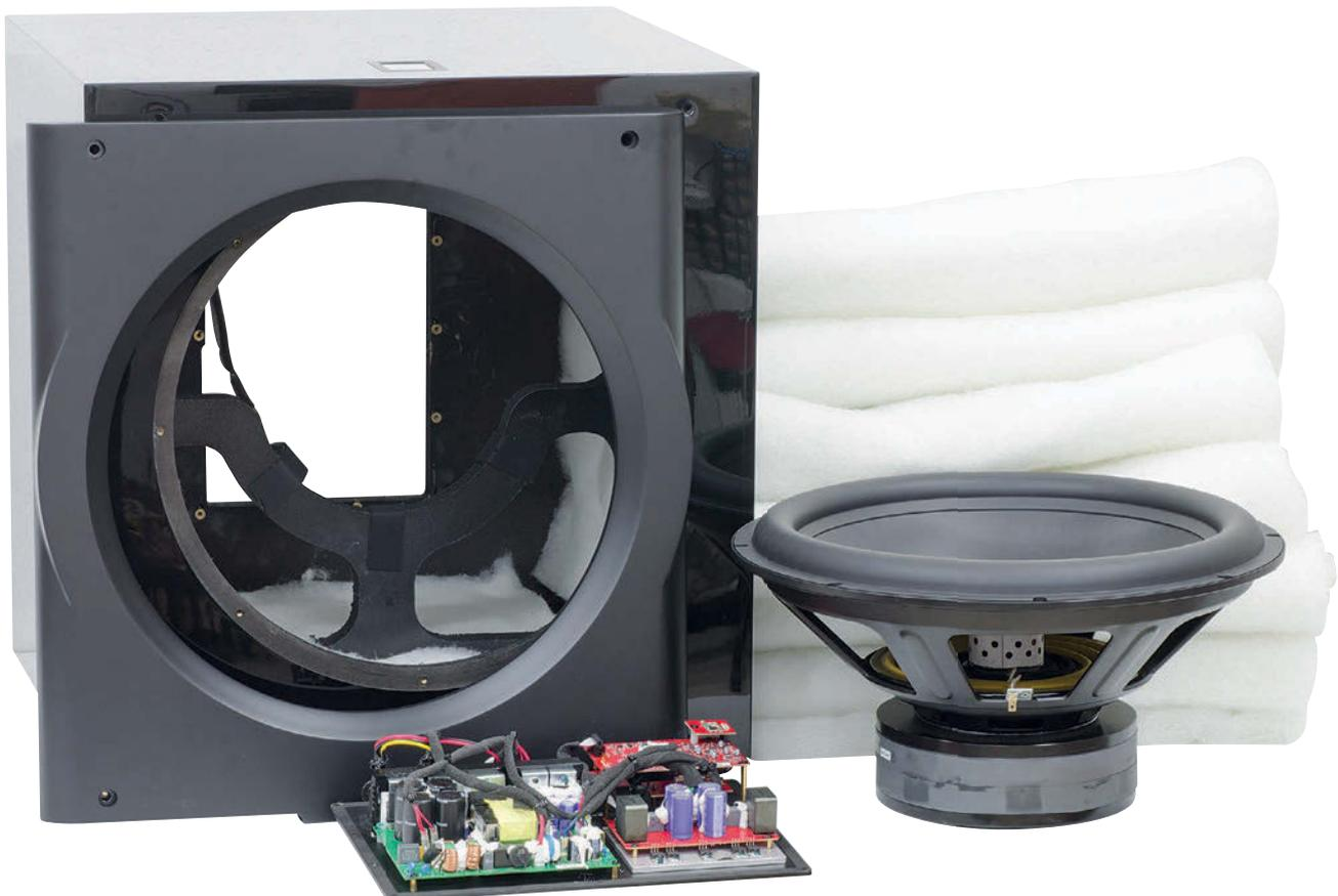
*Il sub disassemblato: la traversa interna di rinforzo fa anche da sostegno al pesante magnete. Il volume è completamente riempito con fonoassorbente fibroso, con cui sono foderate anche 4 pareti interne.*
