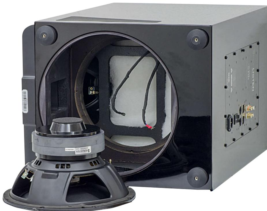
*Rimossa la grande griglia circolare si accede al doppiofondo inferiore, attraverso cui si può smontare il woofer inferiore, montato capovolto. Estratto il woofer inferiore, l'interno del mobile risulta pieno di assorbente acustico acrilico, opportunamente distanziato dal cono tramite la traversa di irrigidimento delle pareti laterali.*
