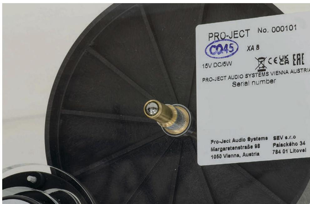
Il perno si inserisce nella boccia di ottone che è innestata all'interno della base. Notare la sfera di acciaio presente sul fondo che riduce l'attrito.
