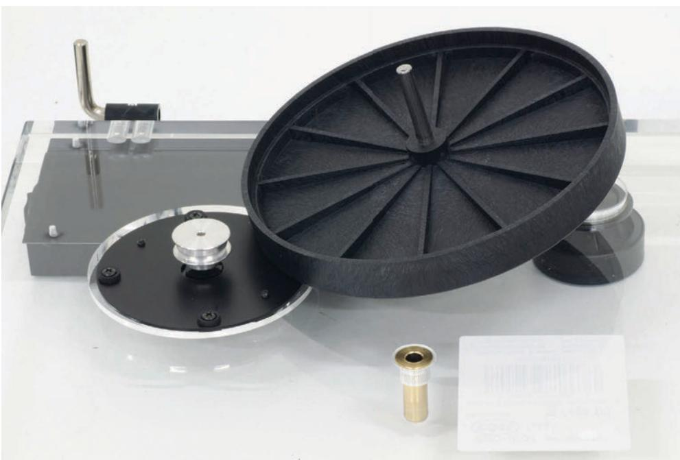
La meccanica di trazione con cinghia corta in cui il motore è vicino al perno e agisce sul sottopiatto. Notare le nervature di irrigidimento nello stampo della plastica, il perno in acciaio lucidato e la boccola in ottone inserita nel telaio.
