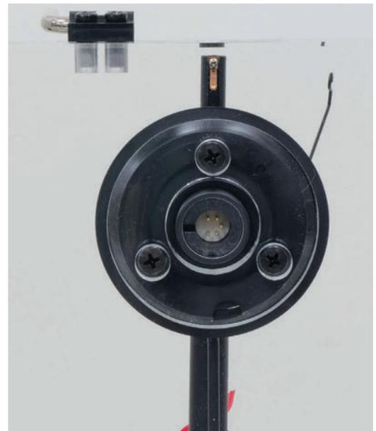
La base del braccio è fissata con tre viti al telaio. Al di sotto si vede il connettore a 5 pin per il cavo.
