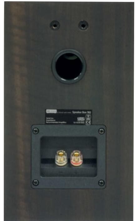
*Sul pannello posteriore degli Speaker Box 5 S2 ci sono le connessioni e l'apertura dell'accordo reflex. La presenza di due fori filettati ne permette il fissaggio a muro mediante opportuni ganci.*
