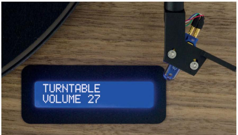
*Un display di due righe a matrice di punti indica la sorgente selezionata e il livello del volume.*
