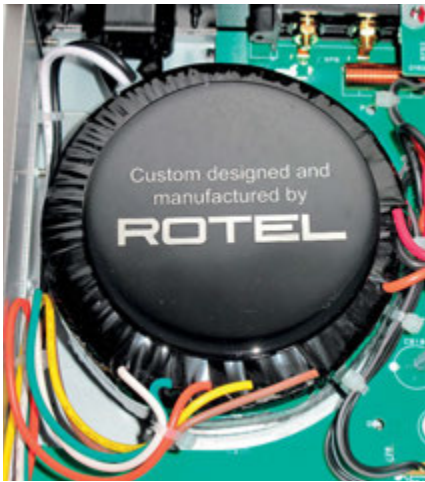
Il bel toroidale da circa 200 VA è custom-made come Rotel è uso fare.
