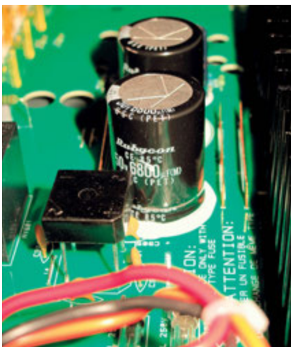
I condensatori di alimentazione dell'A-10, da 6.800 microfarad, sono della Rubycon, marca presente di solito in realizzazioni ben più costose del baby Rotel.
