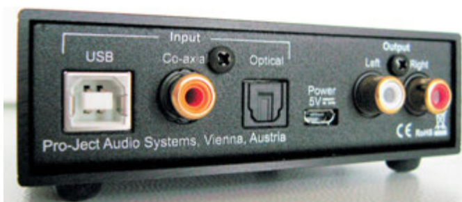
Il pannello posteriore Pro-Ject Pre Box S2 Digital prevede tre ingressi digitali - USB2, coassiale elettrico RCA, ottico TosLink -, la connessione per l'alimentazione a parete e l'uscita stereo analogica RCA.
