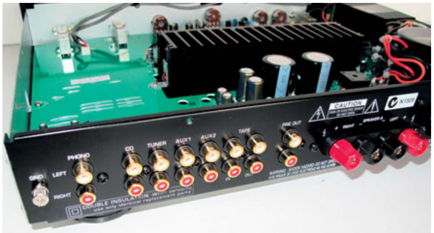
Nonostante il suo prezzo contenuto, l'A-10 è prodigo di ingressi, realizzati con connettori dorati. C'è pure un'uscita PRE OUT, sempre utile all'occorrenza.
