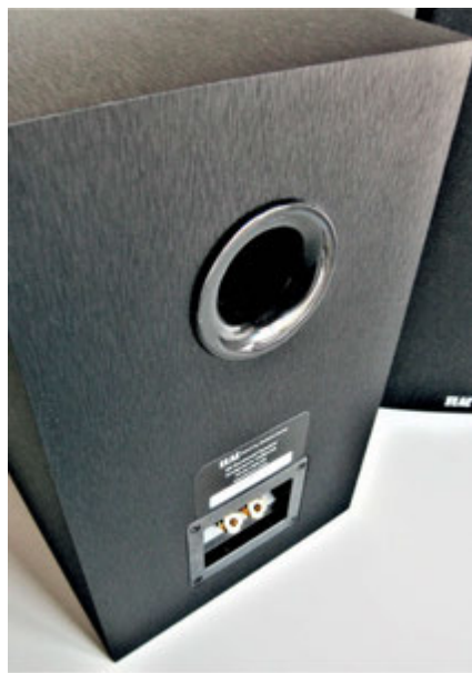
Il condotto del reflex delle B6, leggermente svasato al fine di contenere il rumore prodotto dal flusso d'aria.
