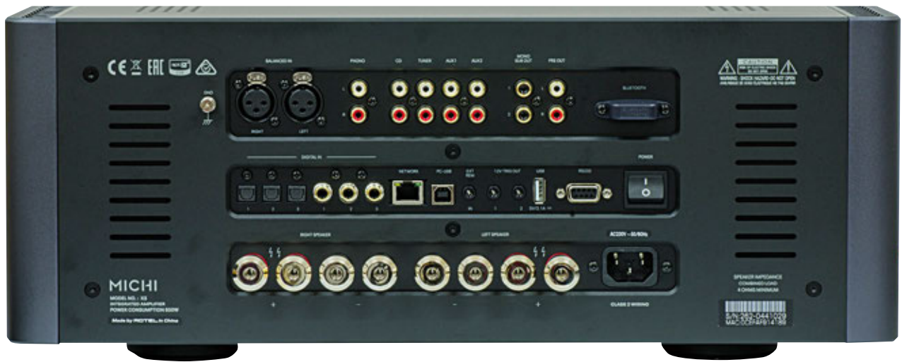
Il pannello posteriore è ampio e accoglie un buon numero di connettori, dagli ingressi analogici bilanciati e sbilanciati a quelli digitali. È presente la porta Ethernet e contemporaneamente quella USB B per poter utilizzare un PC come sorgente. Molto robuste le boccole rodiate che permettono il collegamento in bi-wiring con i diffusori.
