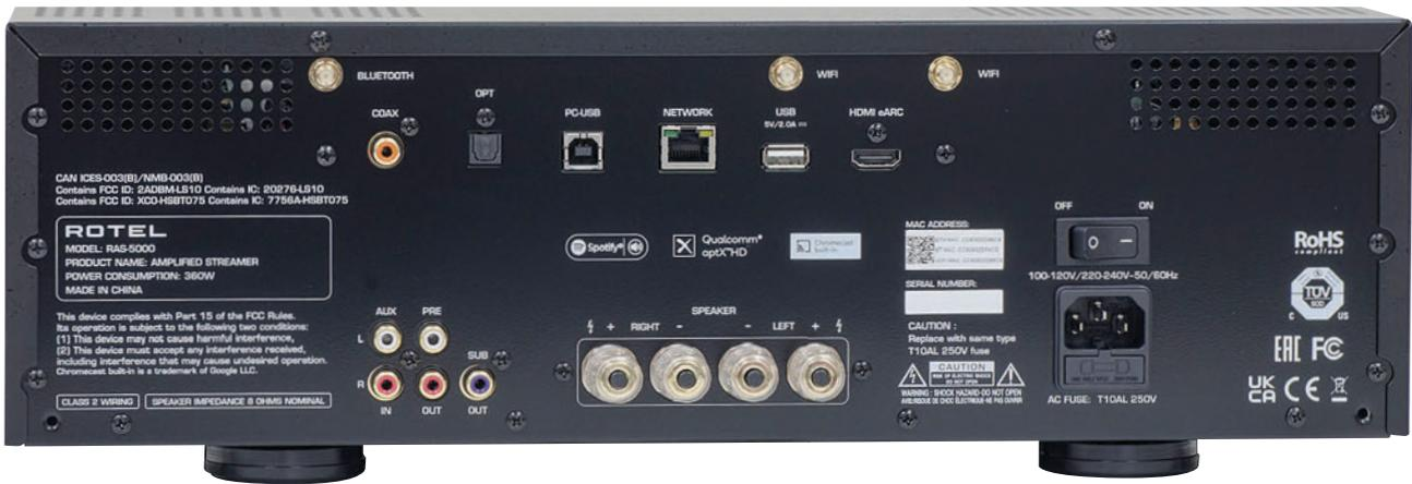
Le connessioni sul retro attestano la versatilità del RAS-5000 in ambito digitale e streaming, a differenza delle ridotte possibilità di interfacciamento verso sorgenti analogiche.
