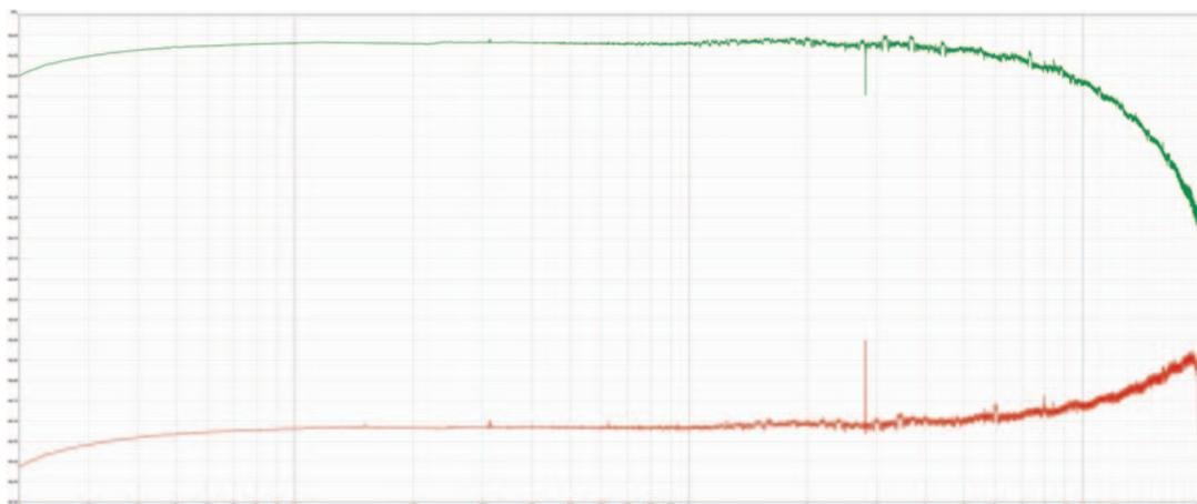
**Risposta in Frequenza:** In verde la risposta in frequenza usando il DAC a bordo del Phonitor xe; in rosso la risposta usando il DAC TEAC UD503, praticamente senza alcuna modifica apportata dal Phonitor xe, nonostante la sua presenza al test.
