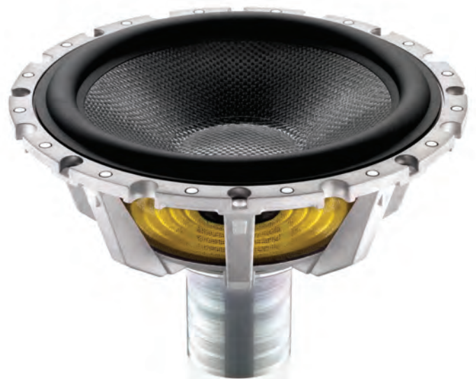
I woofer in Aerofoil con magneti in neodimio che permette una escursione molto ampia dell'equipaggio mobile. Il cestello è in alluminio con campate non riflettenti.
