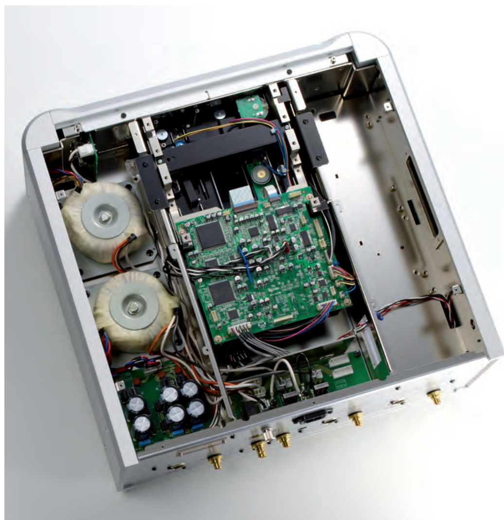
Separate le alimentazioni per digitale e analogico, con sezioni di filtraggio dedicate per ogni stadio. Notare la costruzione a scomparti, che isola sia meccanicamente che dai disturbi ogni sezione funzionale.
