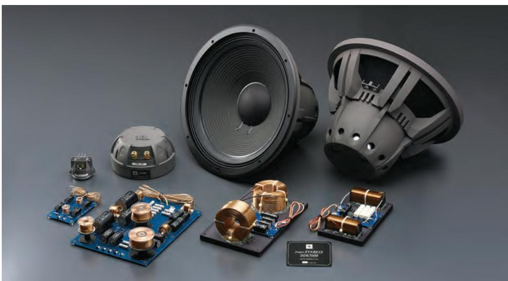
*I componenti che costituiscono le Everest. Notare il complesso magnetico in alnico con fori di ventilazione dei woofer, e le 3 schede cross-over, una per ogni via, oltre, sull'estrema sinistra, la morsettiere di ingresso. Sempre sulla sinistra i due driver per medi ed alti.*
