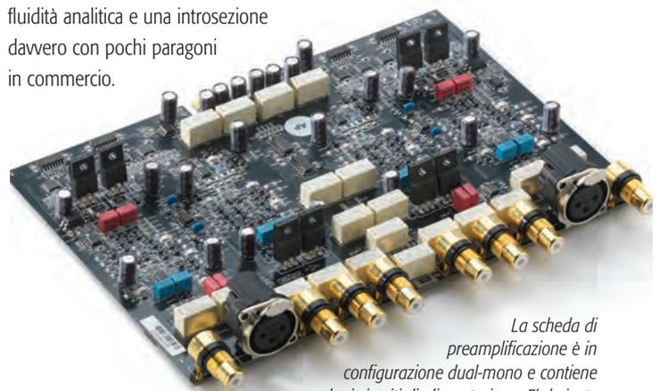
*La scheda di preamplificazione è in configurazione dual-mono e contiene anche i circuiti di alimentazione. E' derivata dal pre top di gamma N°526.*
