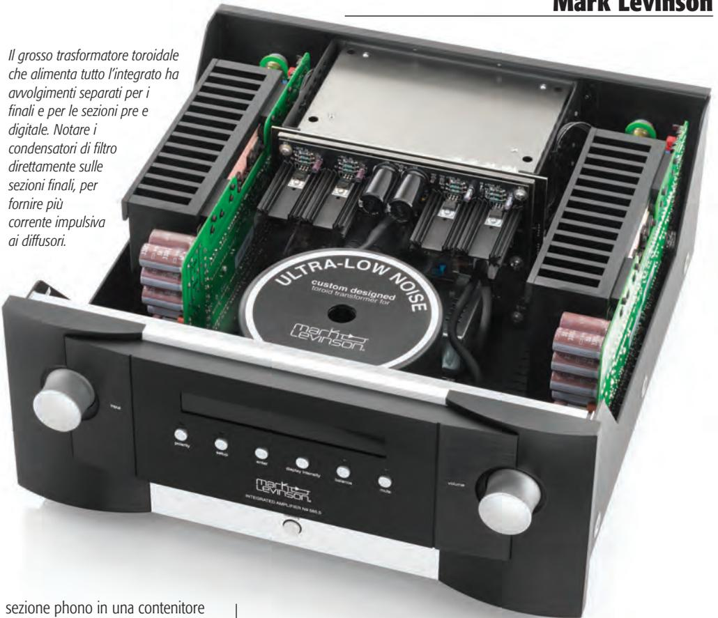
*Il grosso trasformatore toroidale che alimenta tutto l'integrato ha avvolgimenti separati per i finali e per le sezioni pre e digitale. Notare i condensatori di filtro direttamente sulle sezioni finali, per fornire più corrente impulsiva ai diffusori.*
