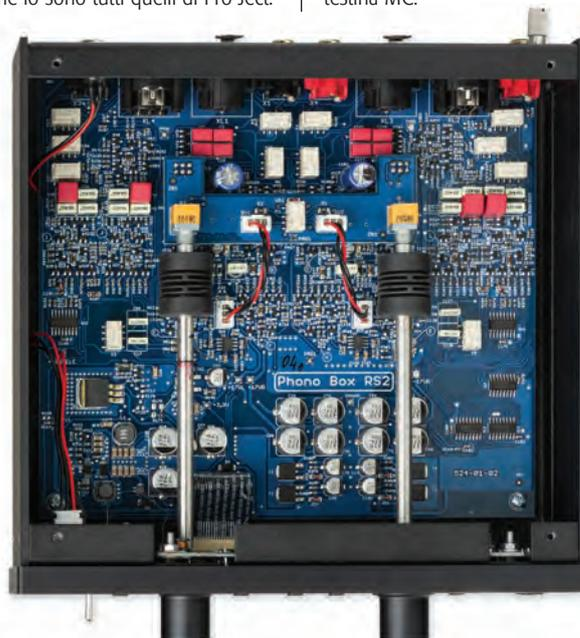
La costruzione di Phono Box RS2 è esemplare. È realizzato completamente a discreti e con componenti di livello assoluto. Notare i condensatori WIMA, per esempio, normalmente a bordo di realizzazioni Hi-End.
